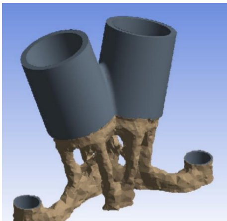
Рис. 5. Результаты топологической оптимизации фитинга (составлено автором)
