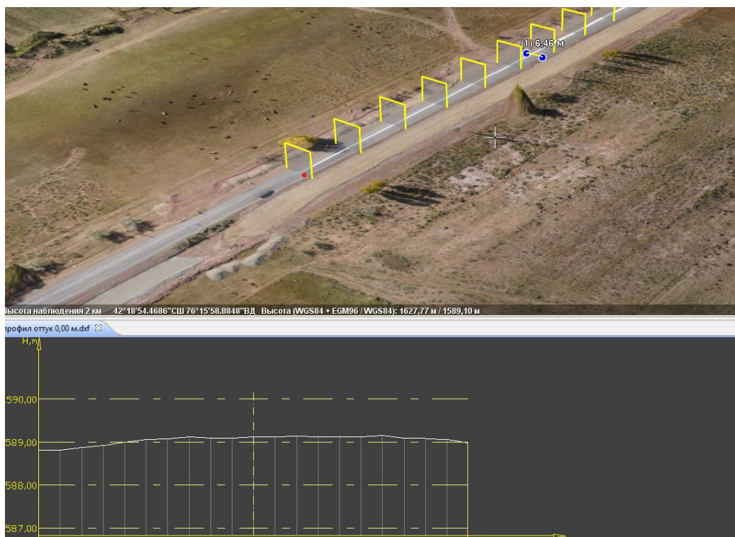
Рис. 3. Измерение уклонов местности
