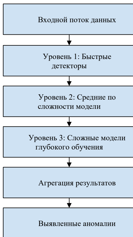
Рисунок 5 – Иерархическая система выявления аномалий
