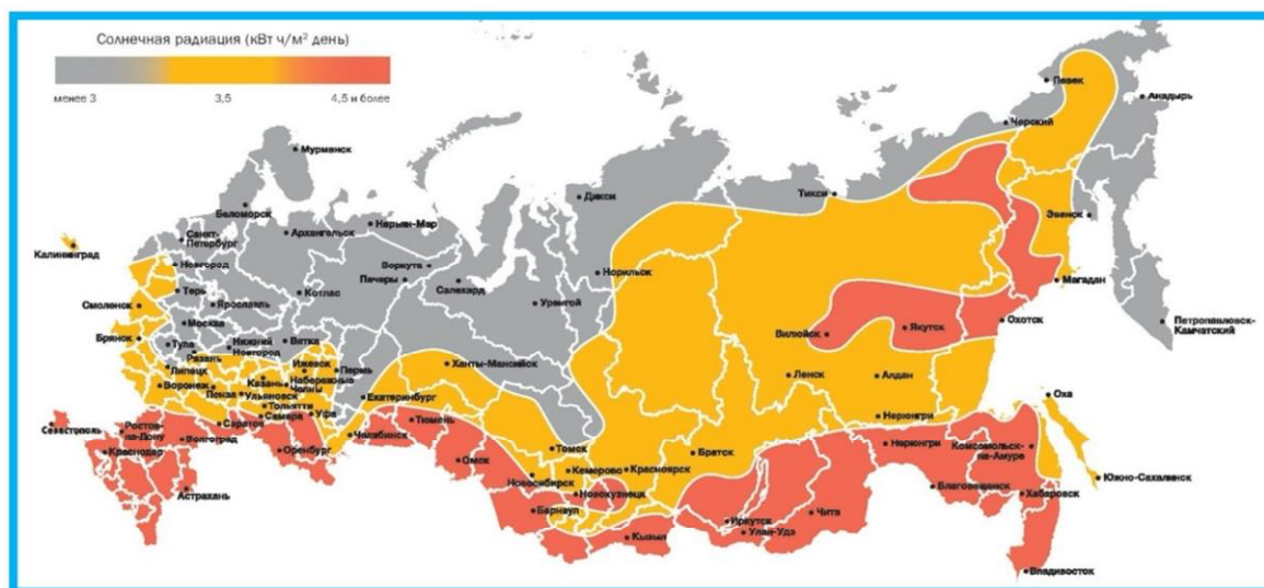
Рисунок 8. Карта солнечной инсоляции по мощности на 1 м 2 солнечных батарей в зависимости от территории
