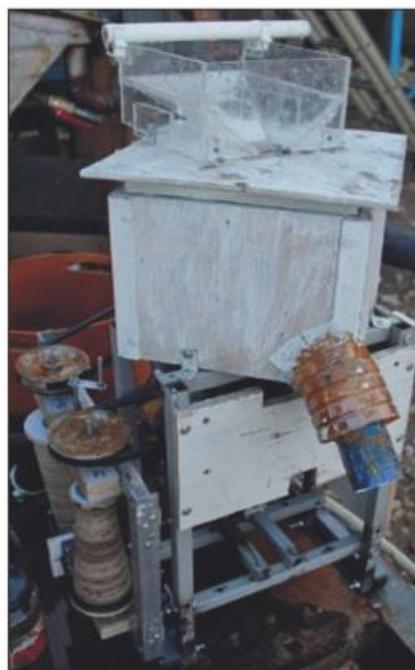
Рисунок 2 – Общий вид лабораторной модели центробежно-вибрационного концентратора. 1 – крышка с приемным бункером, 2 – кожух, 3 – зажимное кольцо, 4 – съёмная футеровка, 5 – узел рабочего органа, 6 – приводной двигатель, 7 – валковый вариатор, 8 – несущая рама, 9 – двигатель вибратора.
