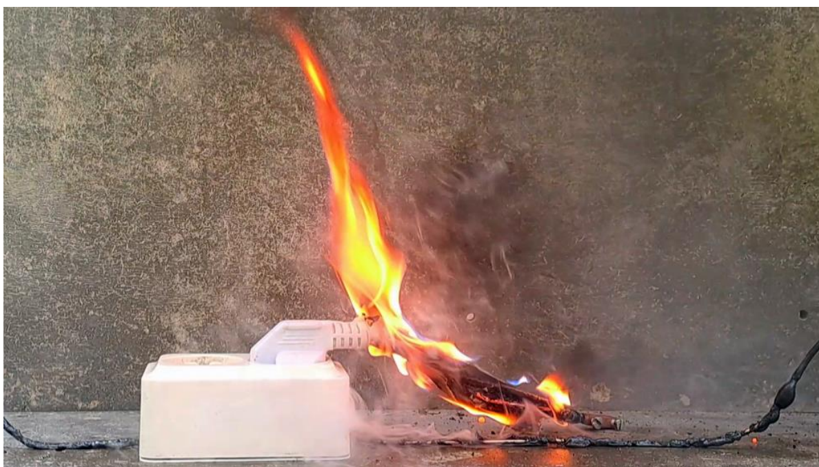
Рис. 5. Пламенное горение неразъёмной вилки и изоляции шнура (3x1,5 мм 2 ) при токе 118...123 А.
