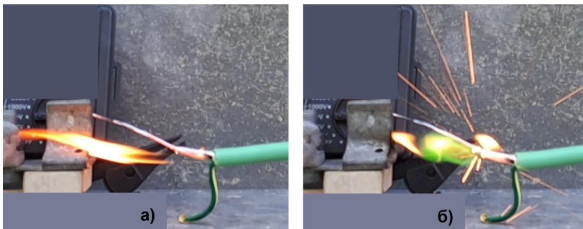
Рис. 7. Результат кумуляции тепла для кабеля ППГнг(А)-HF 3x1,5 при токе 125А и кратности тока перегрузки 125/20≈6: а) выброс пламени из оболочки, б) плавление проводника
