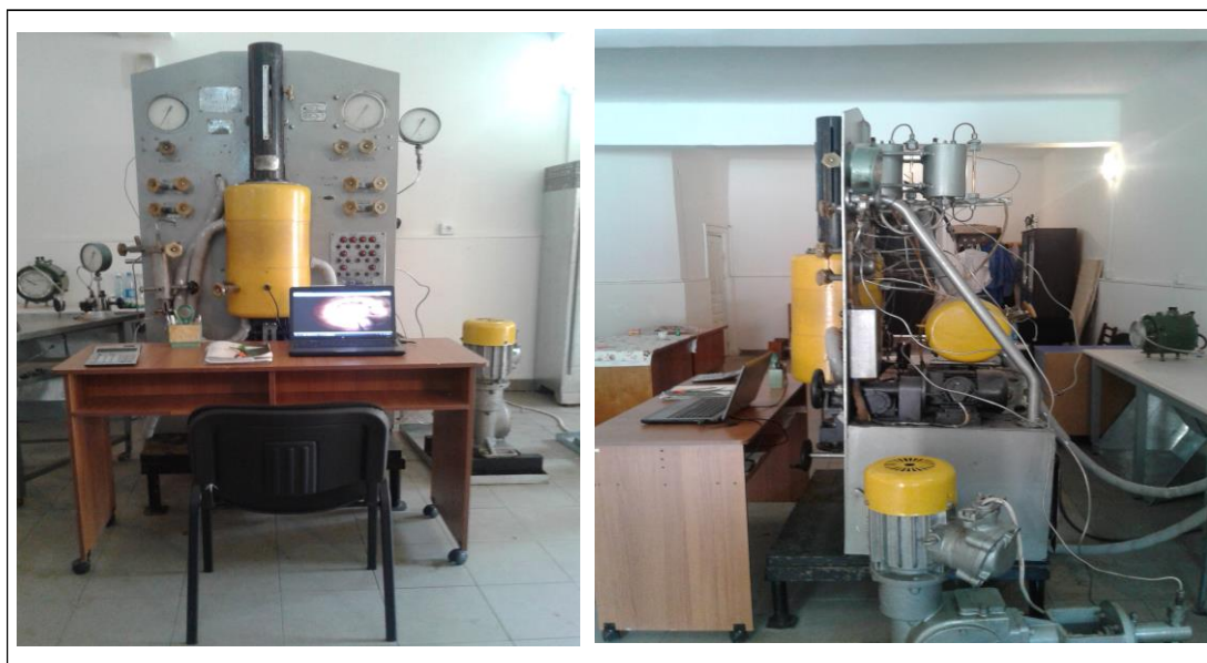
Рисунок 1. Экспериментальная установка - Бомба PVT (типа УКГ-3 с рабочим давлением 45 МПа и рабочей температурой 80°C)
