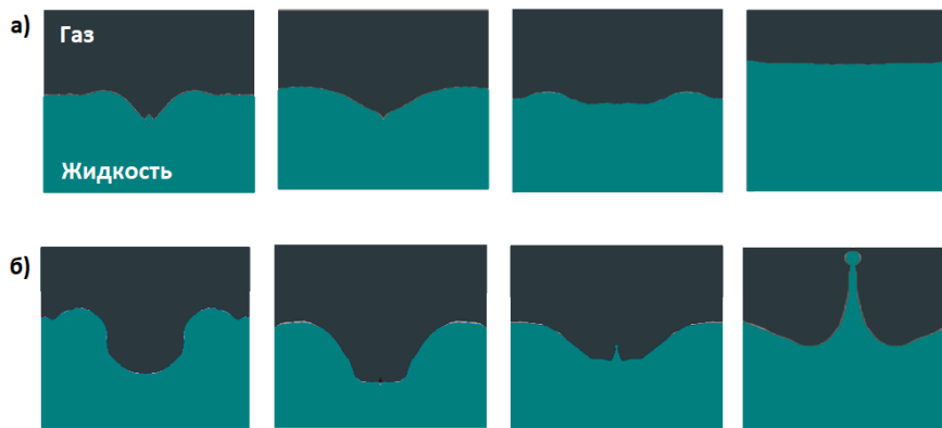
Рис. 2. Визуализация распада цифровой скоростной видеосъемки динамики удара капли о поверхность жидкости; а) отсутствие выброса вторичной капли, б) образование струи Релея с последующим распадом и отделением вторичной капли в газовую среду.
