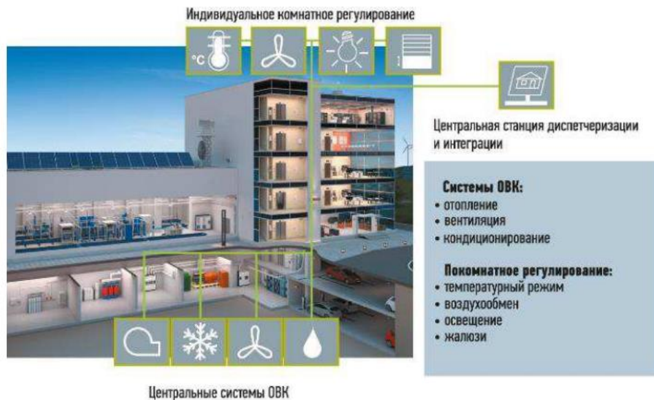
Рисунок 4 – Системы автоматизации здания
