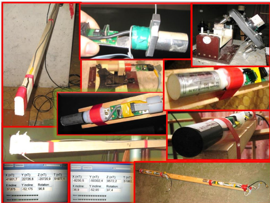
Рис.2. Фото приспособлений изготовленных для исследования различных ФД и ИМ. Фрагменты фото с экрана дисплея ПК (внизу слева) при исследовании ИК с результатами измеренных значений составляющих (X, Y, Z) вектора ВМИ поля Земли и вычисленного модуля (T) в процессе проведения методических работ. Здесь также представлены данные цифровых инклинометров (X, Y, R).
