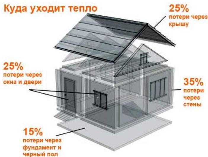
Рис.2.6. Потери тепла через отдельные элементы здания
