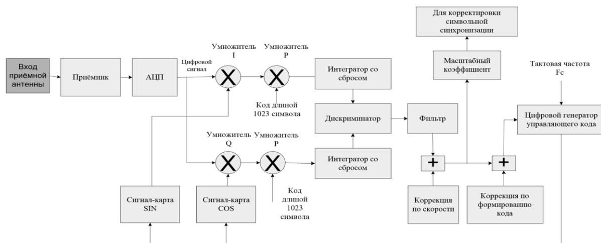
Рис. 2. Схема цифровой обработки, применяемая в системах GPS и ГЛОНАСС.
