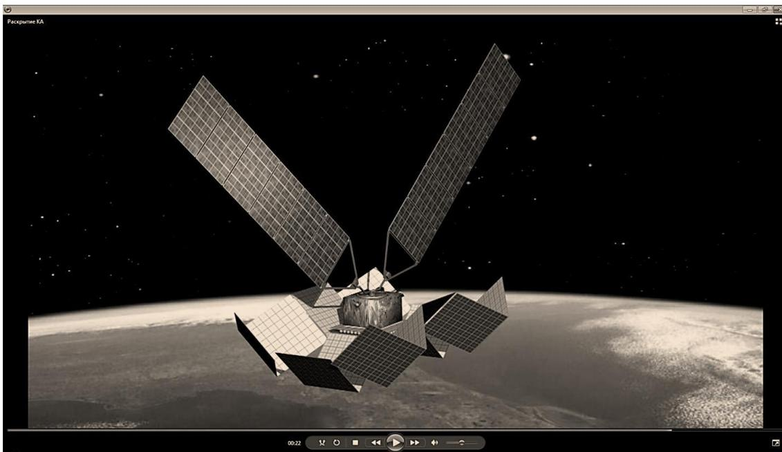
Рис. 6. Пример модели спутника для реализации способа навигации и связи при группировке в 7 КА  $\square$  14орбит  $\square$  98КА с расположением антенн для обзора пятна на Земле (диаметр 4852 км при высоте 650 км) в секторе 360о по углу азимута и 150о по углу места.
