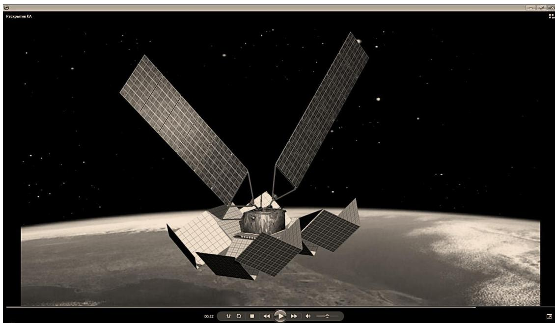
*Рис. 6. Пример модели спутника для реализации способа навигации и связи при группировке в 7 КА  $\square$  14орбит  $\square$  98КА с расположением антенн для обзора пятна на Земле (диаметр 4852 км при высоте 650 км) в секторе 360° по углу азимута и 150° по углу места.*
