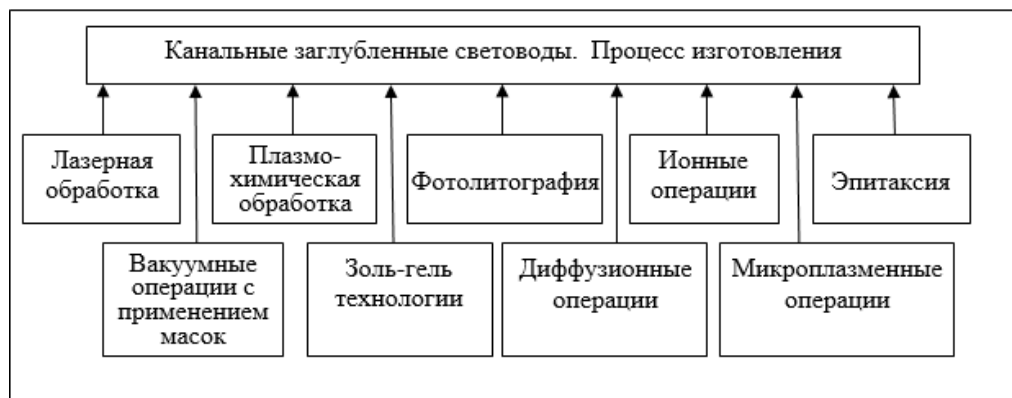
Рис. 2. Схема технологических операций, составляющих процесс формирования световодов
