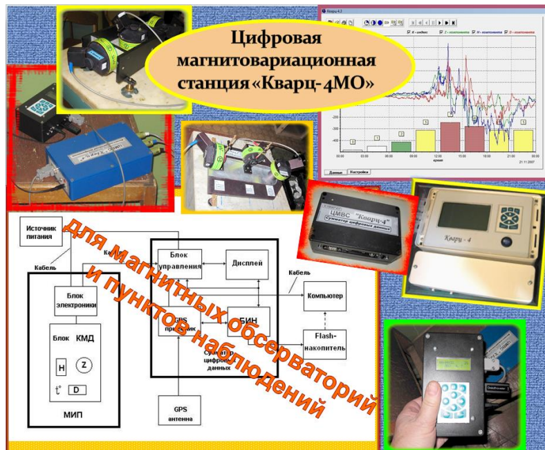
Рис.4. Цифровая магнитовариационная станция «Кварц-4МО».
