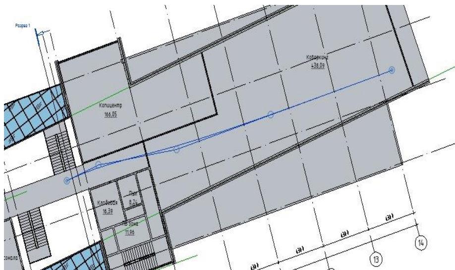
Рисунок 1. Моделирование расстояния от наиболее удаленной точки до эвакуационного выхода
