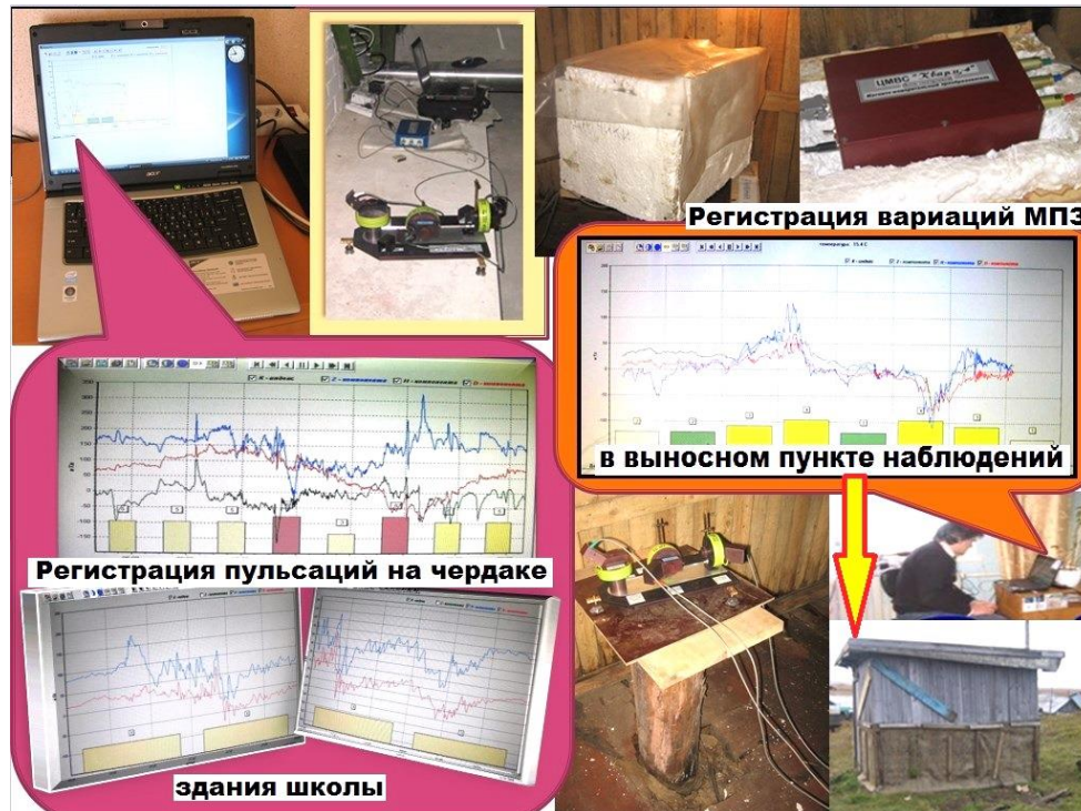
Рис.6. Пункт наблюдений в поселке Сё-Яха и фрагменты магнитограм зафиксированных при помощи ЦМВС «Кварц-4».
