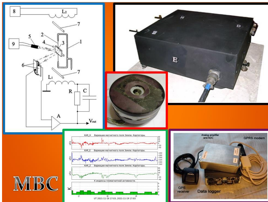
Рис.8. Цифровая МВС, установленная на некоторых ПН в районе КС и фрагмент магнитограммы, зафиксированной на ПН «Карпогоры».
