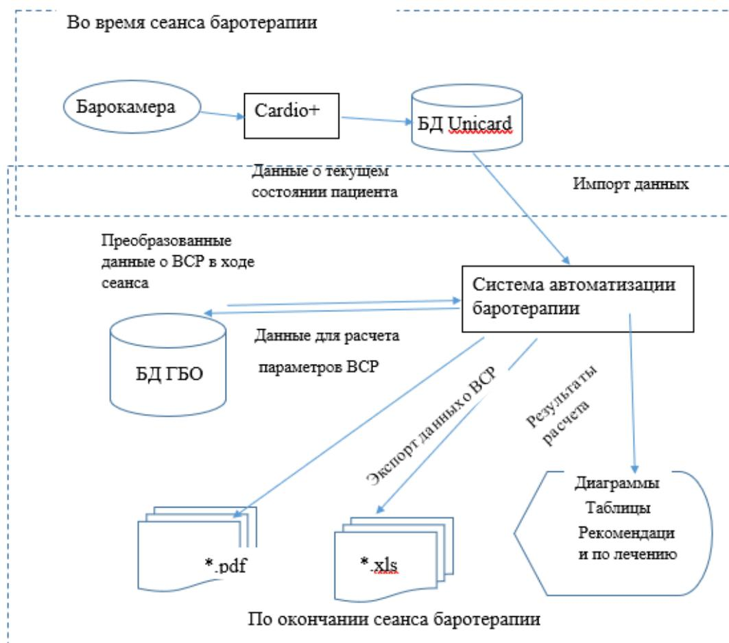
Рис. 1 Схема движения данных в системе
