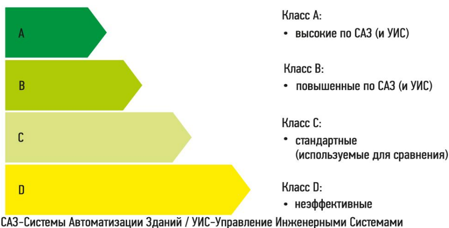
Рисунок 6 – Классы энергетических характеристик систем автоматизации
