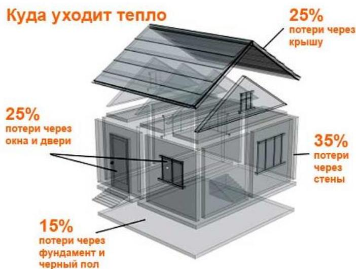
Рис.2.6. Потери тепла через отдельные элементы здания
