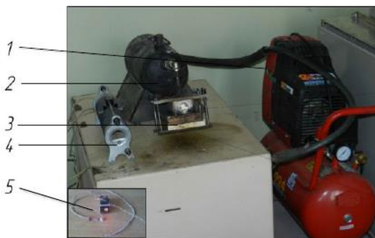
Рис. 1. Установка для продувки песчано-масляной смеси на подсолнечном масле в нагретом воздухе: 1. – компрессор; 2. – воздухонагреватель; 3. – стержневой ящик; 4. – регулятор температуры (резистор); 5. – термопара
